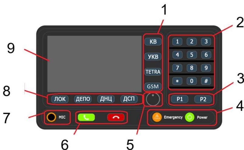
Рисунок 3.11 – Передняя часть консоли терминала
