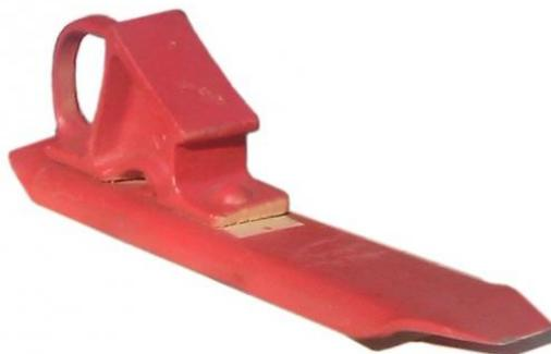
Рисунок 1.2 – Тормозной башмак
