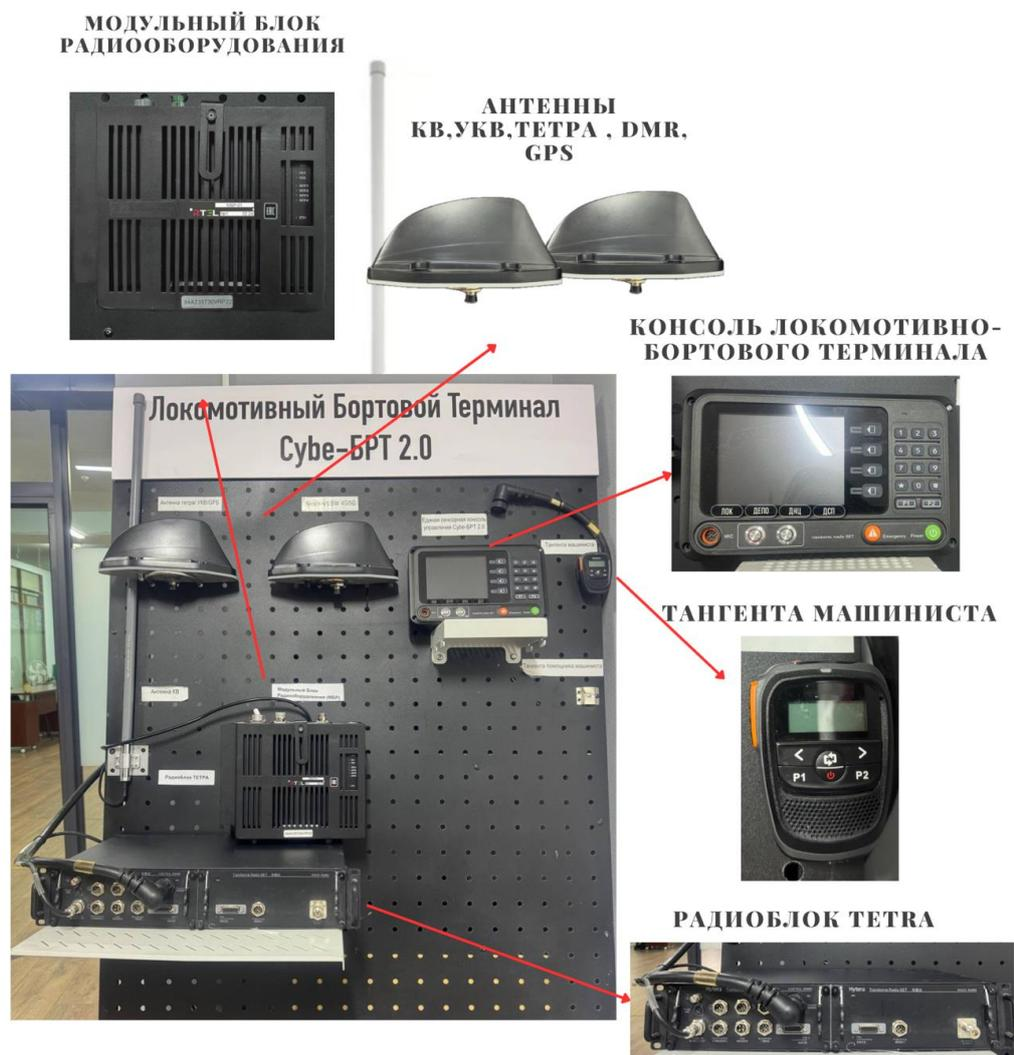
Рисунок 3.13 – Прототип Cybe-BRT
