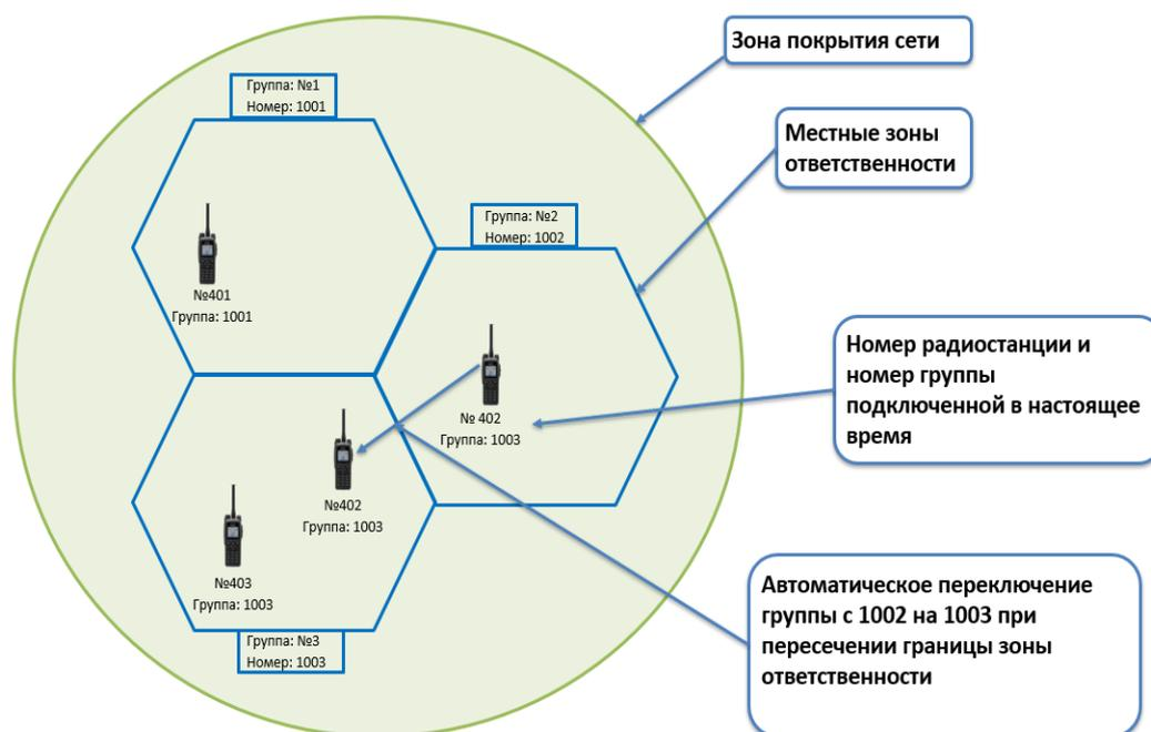
Рисунок 1.5 – Функция автоматического переключения
